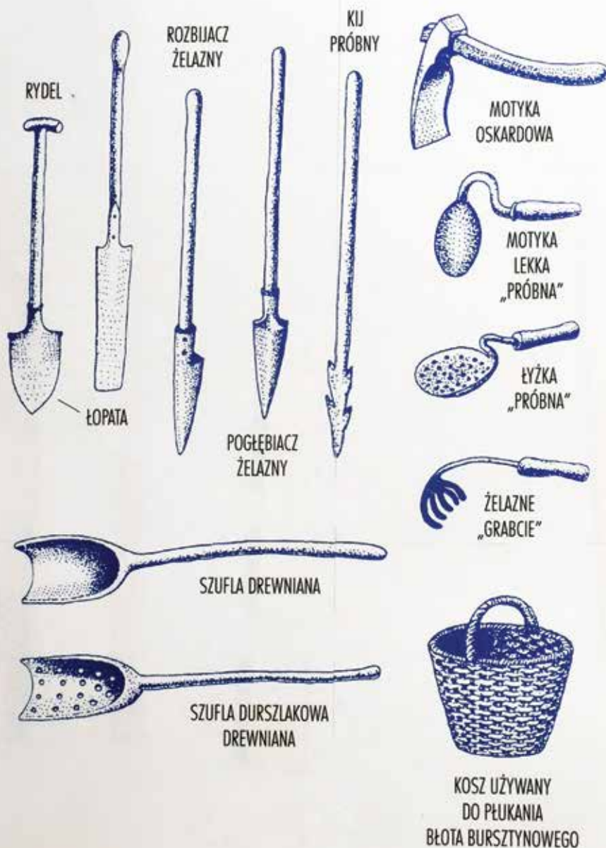
Ryc. 2. Narzędzia do poszukiwania i wydobywania bursztynu
